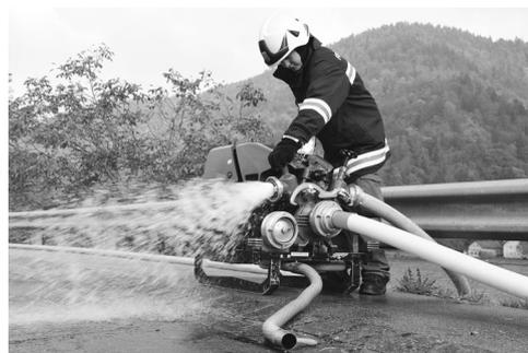
In der Stationsausbildung wurden unter anderem Ansaugübungen durchgeführt und auf die richtige Bedienung der Pumpen durch ein Ausbilderteam hingewiesen. Bewusst eingebaute Fehler an der Tragkraftspritze und Saugleitung sowie simulierte Schlauchplatz-er waren zu erkennen und zu beheben. Auch die Bedienung des hydraulischen Berge-gerätes und der Tauchpumpen wurde vorgezeigt.
